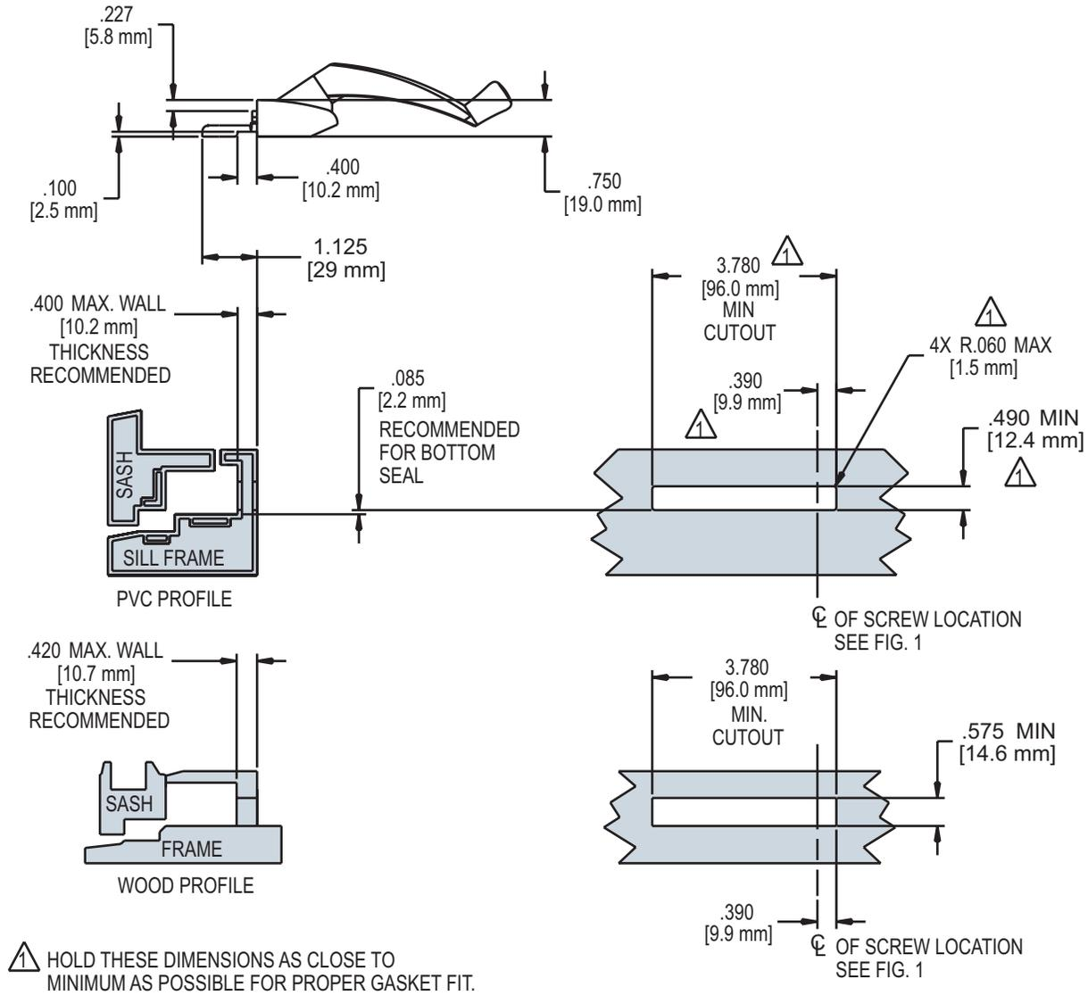
FIG. 3 GASKET APPLICATION FOR ELLIPSE SINGLE ARM OPERATOR
