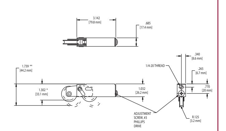
\*FULLY RETRACTED WHEEL POSITION-DIMENSION IS TO INSIDE WHEEL RADIUS \*\*FULLY EXTENDED WHEEL POSITION-DIMENSION IS TO INSIDE WHEEL RADIUS
