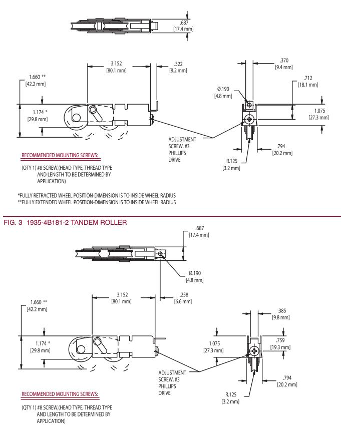
\*FULLY RETRACTED WHEEL POSITION-DIMENSION IS TO INSIDE WHEEL RADIUS \*\*FULLY EXTENDED WHEEL POSITION-DIMENSION IS TO INSIDE WHEEL RADIUS
