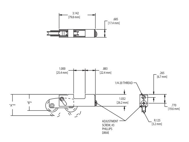
\*FULLY RETRACTED WHEEL POSITION-DIMENSION IS TO INSIDE WHEEL RADIUS \*\*FULLY EXTENDED WHEEL POSITION-DIMENSION IS TO INSIDE WHEEL RADIUS
