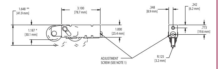
\*FULLY RETRACTED WHEEL POSITION-DIMENSION IS TO INSIDE WHEEL RADIUS \*\*FULLY EXTENDED WHEEL POSITION-DIMENSION IS TO INSIDE WHEEL RADIUS
