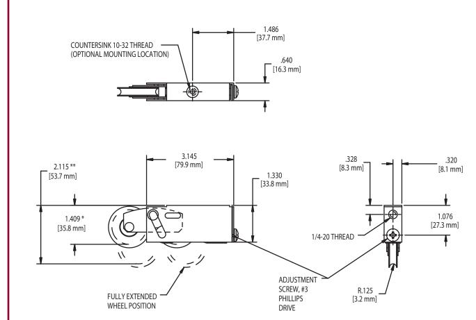
\*FULLY RETRACTED WHEEL POSITION-DIMENSION IS TO INSIDE WHEEL RADIUS \*\*FULLY EXTENDED WHEEL POSITION-DIMENSION IS TO INSIDE WHEEL RADIUS
