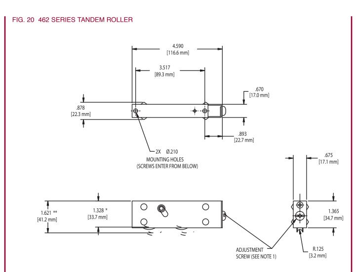
\*FULLY RETRACTED WHEEL POSITION-DIMENSION IS TO INSIDE WHEEL RADIUS \*\*FULLY EXTENDED WHEEL POSITION-DIMENSION IS TO INSIDE WHEEL RADIUS
