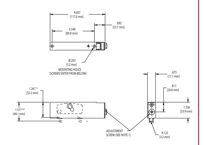
\*FULLY RETRACTED WHEEL POSITION-DIMENSION IS TO INSIDE WHEEL RADIUS \*\*FULLY EXTENDED WHEEL POSITION-DIMENSION IS TO INSIDE WHEEL RADIUS
